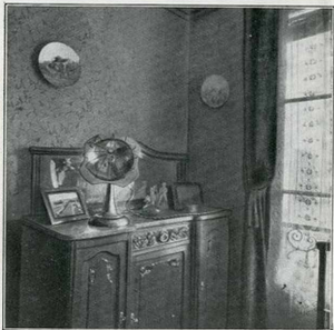
Fig. 1. — Radiateur parabolique 500 W utilisé dans une salle à manger pour chauffage d'intersaison.
